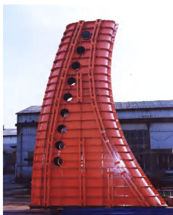
防雪柵型枠(高:8m×幅:5m×幅1.5m)
