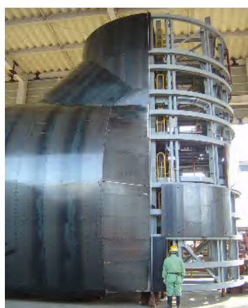
立坑&水平坑取合部用特殊型枠
