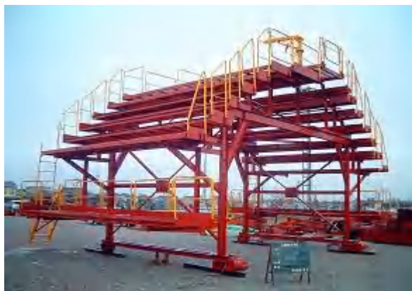
高速道路用シート張り台車
