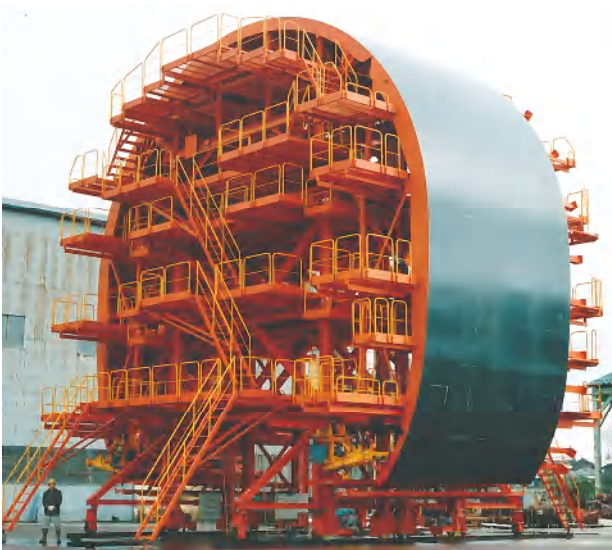
地下調整池用スチールフォーム (幅:15.6m×高:16.5m×長:6m)
